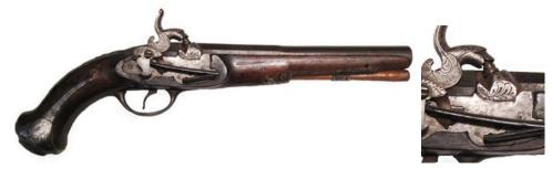
Pistola comercial, manufactura catalana, transformada como arma de pistón, calibre "de á 23". Cañón con culatín simulado, longitud 234 mm, con punzón ilegible de constructor, dañado en la transformación. Llave á la española, caja de caña entera, guarniciones de hierro, con gancho de cinto
