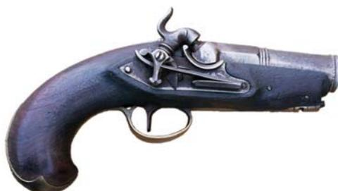
**PIEZA N° 1962-636:** Pistola de bolsillo, manufactura catalana, hacia 1840, sin marcas de constructor. Cañón longitud 80 mm., con culatín, ochavado en su primera mitad, cilíndrico el resto, con anillo de refuerzo en la boca, diámetro del ánima 16 mm. Llave
