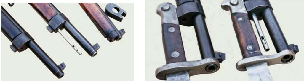
**EN LA CARABINA MAUSER Md. N°2 DE FABRICACIÓN ALEMANA (CENTRO) LA LONGITUD DEL EXTREMO DEL CAÑÓN ES IDÉNTICA A LA DE LA CARABINA MAUSER Md. 1895, EN TODO CASO, MENOR QUE EN LA DE FABRICACIÓN NACIONAL. ESTA DIFERENCIA DE LONGITUD, EN NINGÚN CASO SUPONE MENOSCABO EN LA CORRECTA FIJACIÓN DEL CUCHILLO BAYONETA**
