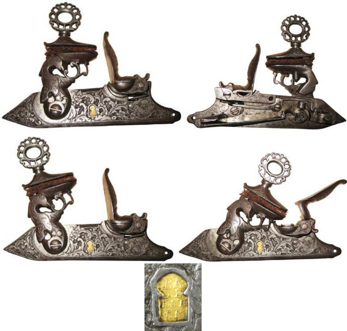
**PIEZA N° 1962-308: Llave de chispa “mixta”, con punzón “BA/LL/EST/ER”. Manufactura catalana. Mecánica totalmente inusual, con único punto al exterior para la fijación del pie de gato en posiciones de seguro y disparo, utilizando como resorte del rastrillo, la prolongación del resorte del fiador, que atraviesa la platina mediante un taladro. Longitud total de la pieza: 355 mm.**
