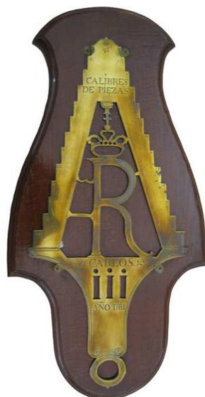
**PIEZA N° 2000-1233:** Calibrador de plancha, en bronce, enmarcado (41 x 18,6 centímetros), inscrito “CALIBRES DE PIEZAS”, con Cifra Real de Carlos III y fecha “AÑO 1781”, señalando el diámetro correspondiente a los calibres de  $\frac{1}{4}$ ,  $\frac{1}{2}$ , 1, 2, 3, 4, 6, 8, 12, 16, 18, 24 y 36 libras.
