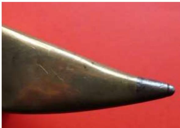
Detalle que indica gran calidad de fabricación. Se trata de una muy bien trabajada punta “acerada” de la parte final de la contera con el objeto de proteger el final de la vaina de aplastamientos y rozaduras en esta zona sensible. Eso en el supuesto, insisto, en que esas fueran las primeras versiones pues bien hubieran podido ser las segundas, más reforzadas en este punto delicado, para atender las posibles quejas de los usuarios de los regimientos artilleros.
