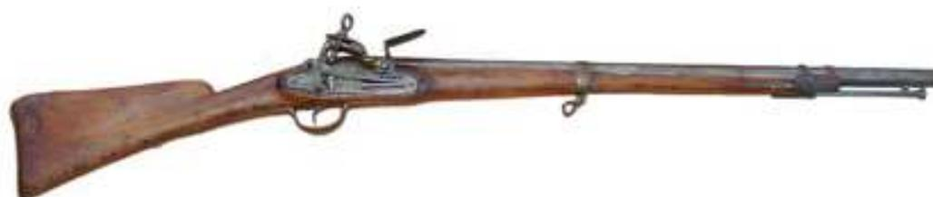
**Mosquetón de munición, para artilleros montados. Cañón calibre “de á 17” (18 mm), longitud 660 mm, con cuadrado para engarce de bayoneta-machete, situado en su mitad inferior. Llave “á la española” en variante vizcaína, marcada la platina “FA. VA.” (Fábrica de Valencia). Longitud total del arma: 1.037 mm. Ejemplar falto de la anilla portafusil, situada en la culata.**
