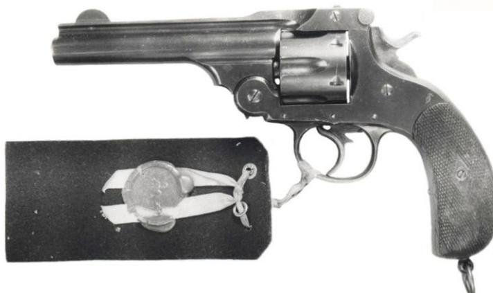
**Muestra del revolver fabricado por “Trocaola, Aranzabal y Comp<sup>a</sup>” en calibre 455 British, aprobado para el Ejército británico con la nominación: “Pistol O.P. with five inch barrel No 2 Mark 1”**
