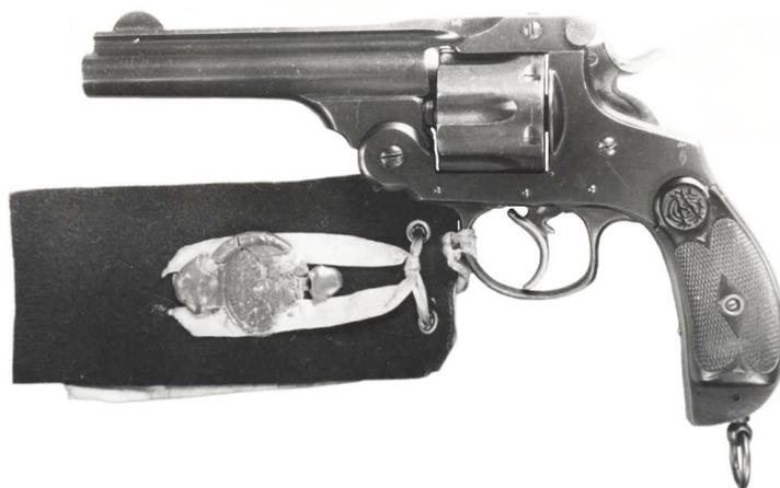
**Muestra del revolver fabricado por “Garate, Anitua y Comp<sup>a</sup>” en calibre 455 British, aprobado para el Ejército británico con la nominación: “Pistol O.P. with five inch barrel No 1 Mark 1”**
