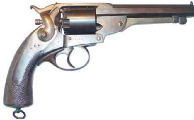
**Revolver Kerr modelo 1862 de Marina. 5 tiros, Cal. 11 mm cañón longitud 146 mm, con prueba de la Fábrica de Placencia, número 1.481**
