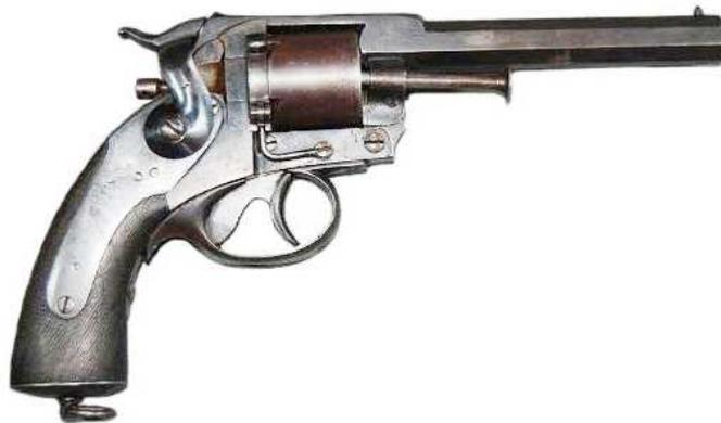
**Revolver Kerr de Marina, Md. 1864, transformado para el uso de cartuchería metálica, según Md. 1870. Foto H. J. Meruelo**
