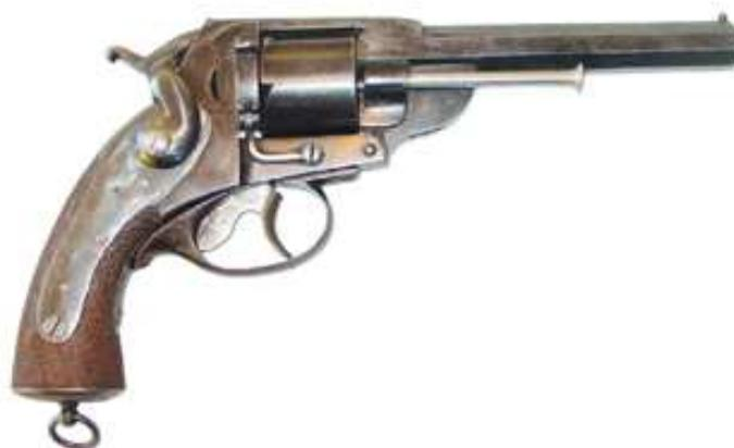
**Revolver Kerr de Marina, Md. 1862, transformado para el uso de cartuchería metálica, según Md. 1872**
