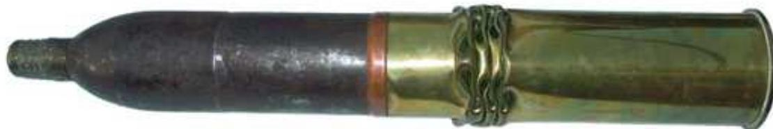
**ASÍ QUEDÓ EL DISPARO, QUE PATXI PRETENDIÓ INTRODUCIR EN UNA PIEZA DE CALIBRE INFERIOR...** No fue exactamente así, se trata de un “montaje” en que se han reunido tres piezas adquiridas por separado: una espoleta de doble efecto y mixto helicoidal, francesa, modelo 1897, una granada de metralla, de 7,5 cm. y la vaina del disparo, manipulada artesanalmente para constituir decorativo jarrón florero... “recuerdo” de la Gran Guerra que asoló Europa en los años 1914-18.
