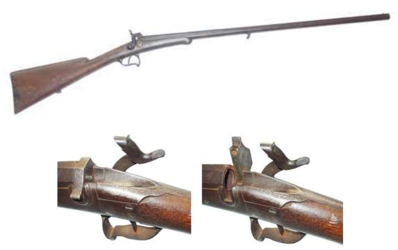
Escopeta de retrocarga para cartuchos de espiga, calibre 16, sin reseña de constructor. Cañón fijo, octogonal en el primer tercio y cilíndrico el resto, mediante el que introducir el cartucho directamente. Cierre de giro en bisagra, llave a la caja con martillo percutor lateral, media caña en hierro. Longitud del cañón 770 mm, longitud total del arma 1,170 m. Peso 2,38 Kgr.
